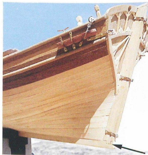
Le tableau arrière en cours de finition. On remarque la mortaise entre le talon de quille et l'étambot.
